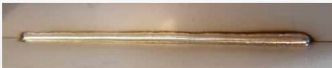
TIG DC folyamatos sarokvarrat további anyag nélkül a Dynamic Arc funkcióval
