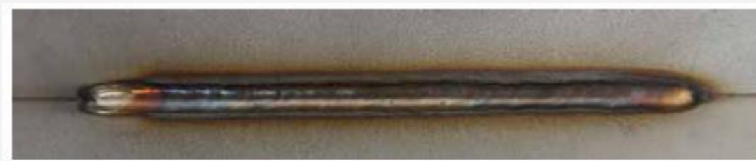
TIG DC folyamatos sarokvarrat további anyag nélkül
